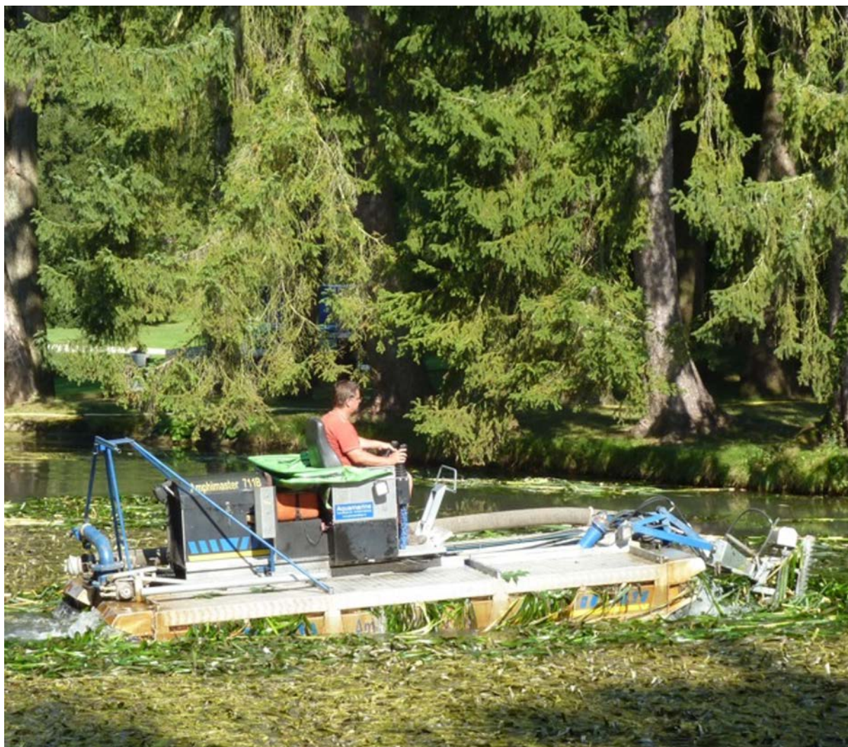
Abbildung 7: Beispiel eines amphibischen Schlamm-saugers im Einsatz im Wenkenpark in Riehen (Foto: Kury, Life Science).
