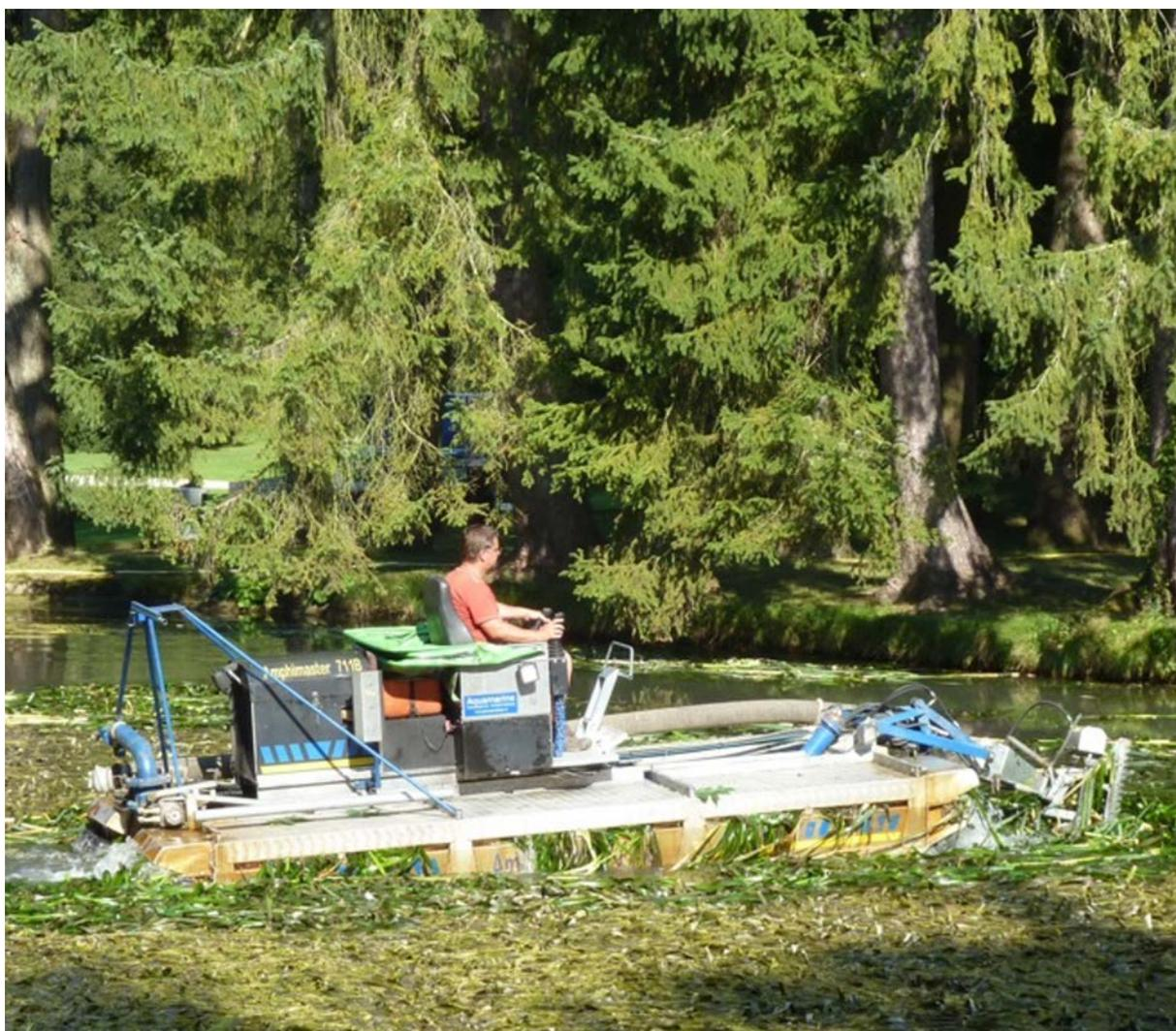
Figure 7: Exemple d'un aspirateur de boue amphibien utilisé dans le Wenkenpark à Riehen (Photo : Küry, Life Science).
