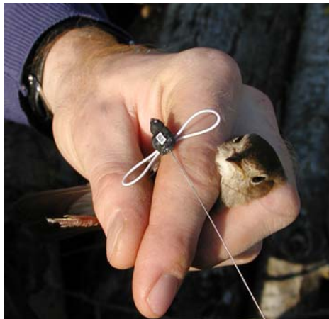
Abb. 7.17. Telemetriesender mit Rucksackschlaufen und Nachtigall
