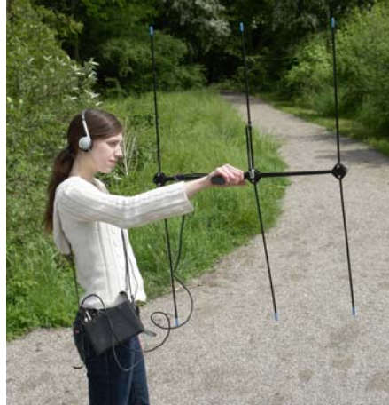
Abb. 7.18. Radiotelemetrie mit einer Yagi-Antenne
